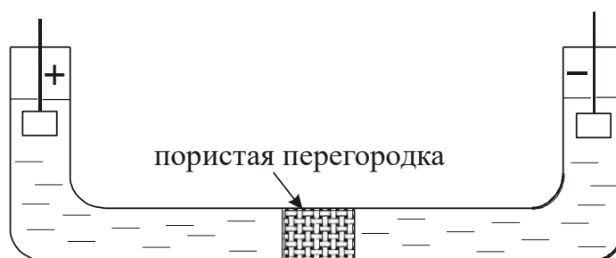
Рис. 4.38. Схема установки для изучения электромиграции ионов актиноидов
